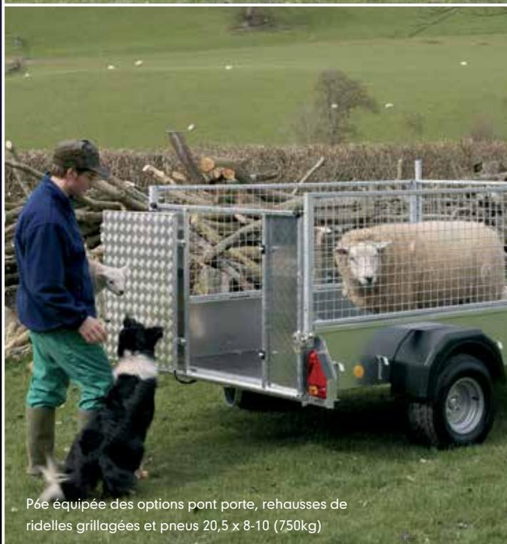
P6e équipée des options pont porte, rehausses de ridelles grillagées et pneus 20,5 x 8-10 (750kg)
